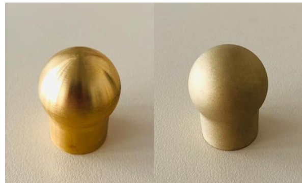
Figure 10. Électrodes hémisphériques avec polissage (à gauche) et sablé (à droite) à utiliser pendant ce cours.
