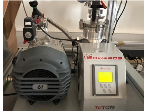
Figure 5. Système de pompage utilisé, qui consiste en une pompe primaire, une turbopompe moléculaire et un système de contrôle électronique.
