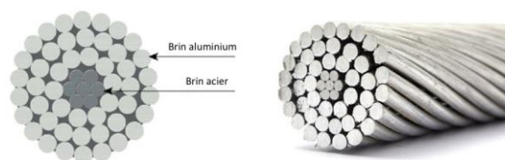
Figure 1 : section et vue globale d'un câble ACSR (Aluminum Conductor Steel Reinforced) [1].
